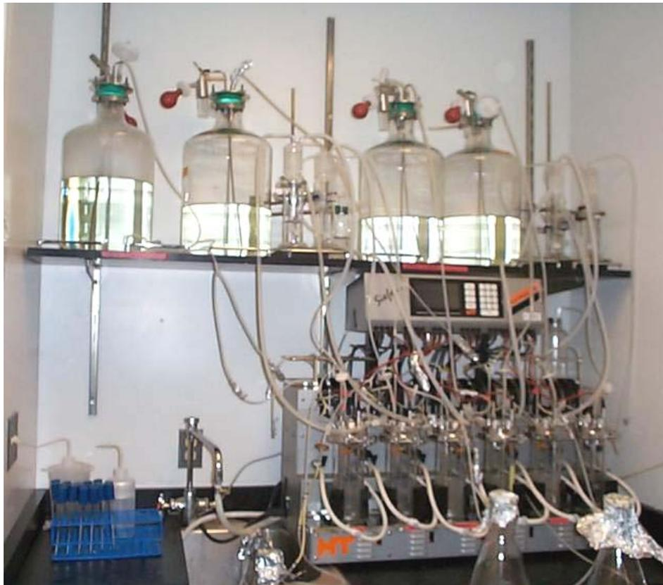
Рис.4 Хемостат в лаборатории.
